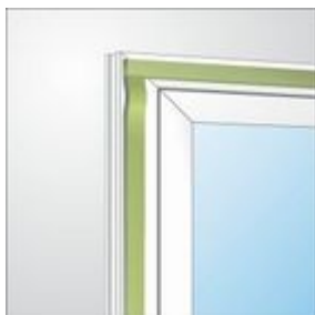
Ilustracja 1: Sposób przyklejenia taśmy uszczelniającej podczas montażu okna.
