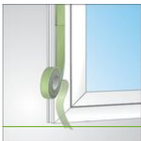
Ilustracja 1: Sposób przyklejenia taśmy uszczelniającej podczas montażu okna.
